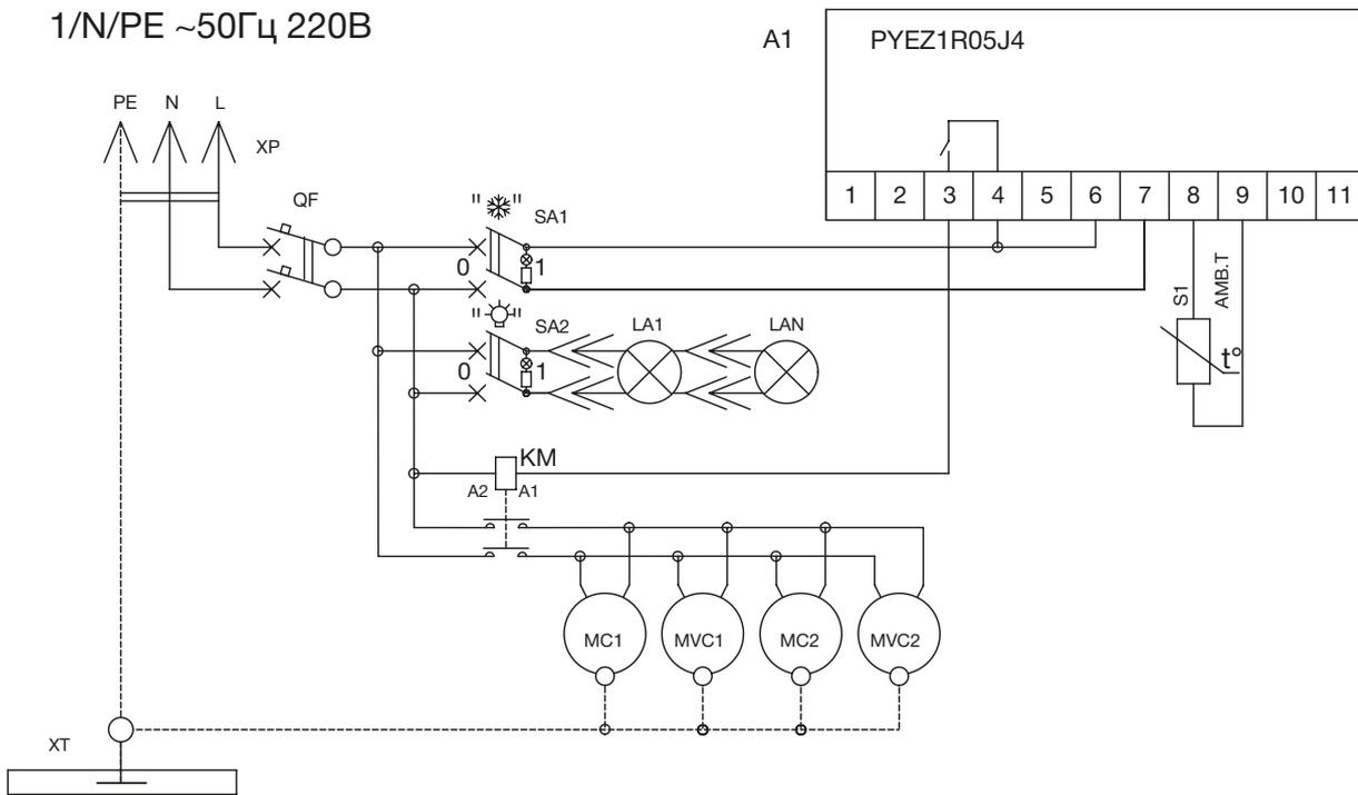
Схема электрическая принципиальная витрины холодильной
