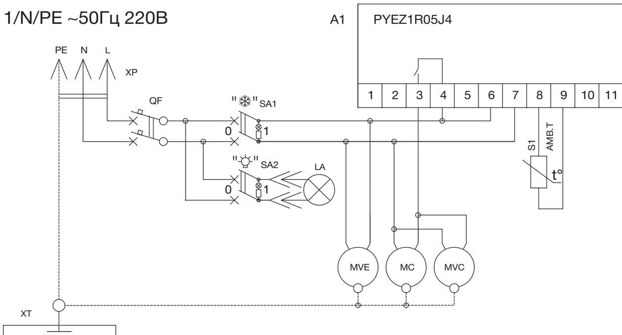
Схема электрическая принципиальная витрины холодильной
