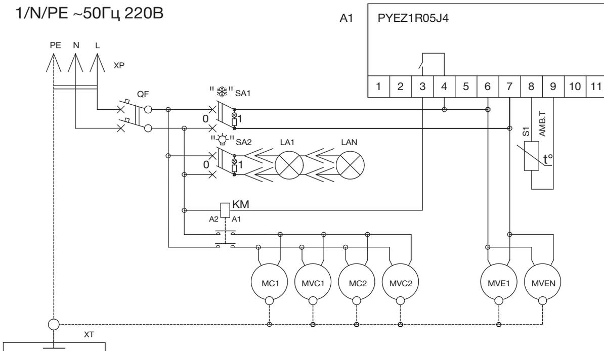
Схема электрическая принципиальная витрины холодильной
