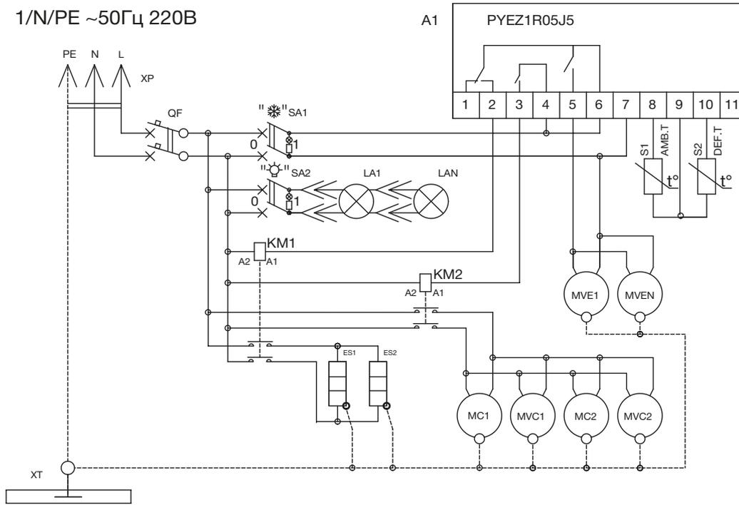
Схема электрическая принципиальная витрины холодильной
