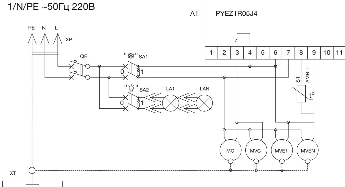
Схема электрическая принципиальная витрины холодильной
