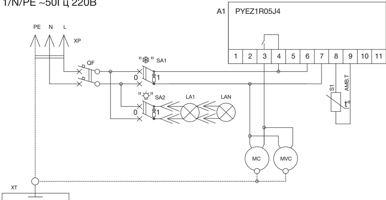
Схема электрическая принципиальная витрины холодильной
