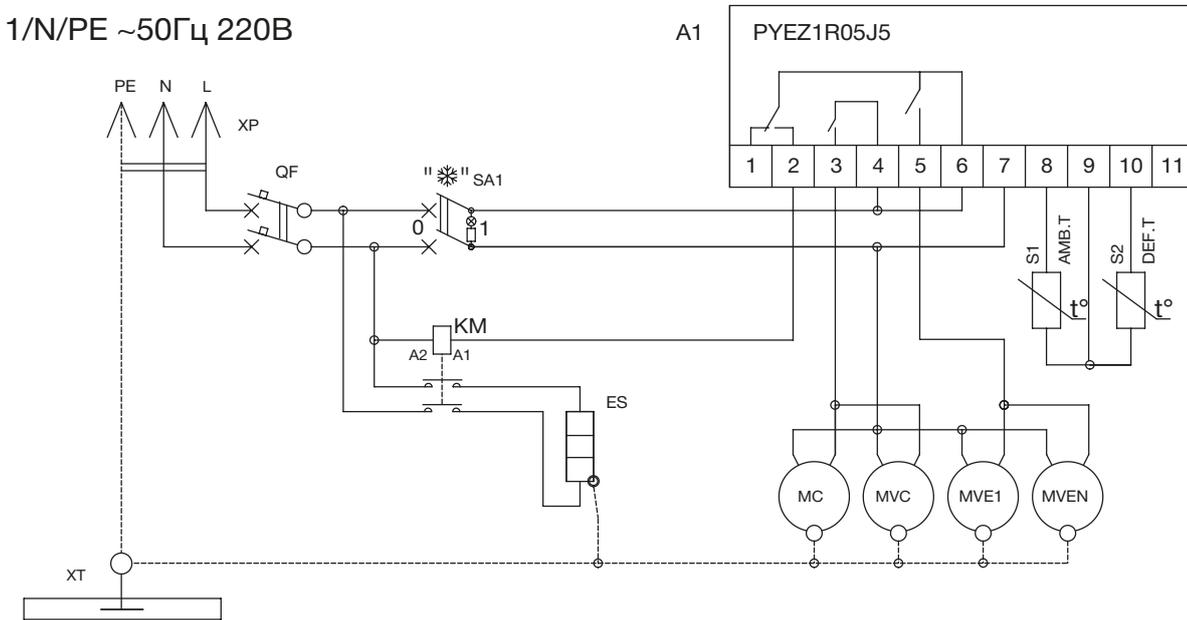
Схема электрическая принципиальная витрины холодильной Galaxy 080 Plug in вентилируемой среднетемпературной 375.
