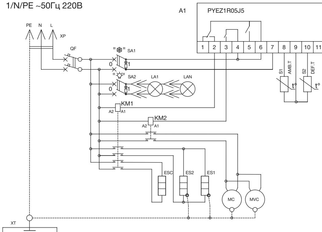
Схема электрическая принципиальная витрины холодильной
