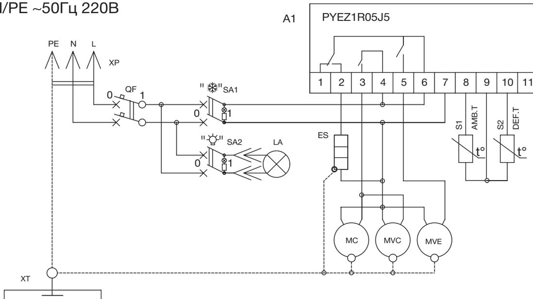
Схема электрическая принципиальная витрины холодильной
