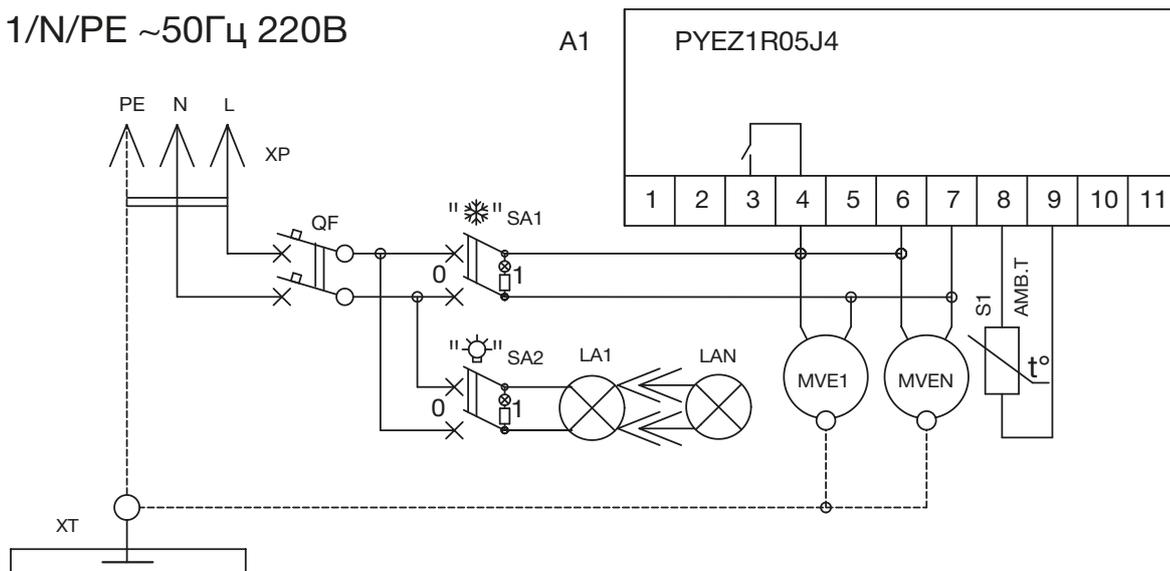
Схема электрическая принципиальная витрины холодильной
