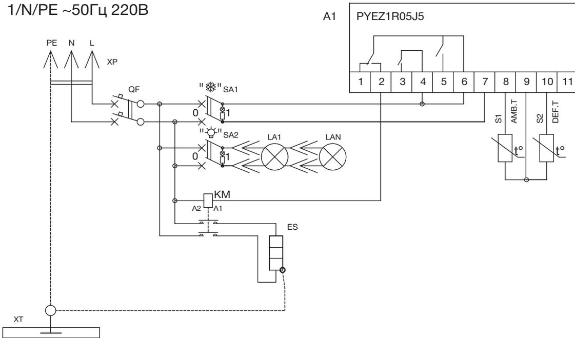
Схема электрическая принципиальная витрины холодильной
