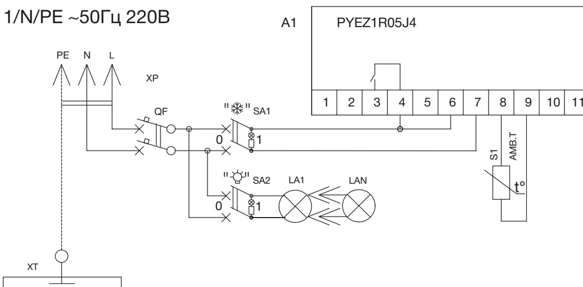
Схема электрическая принципиальная витрины холодильной
