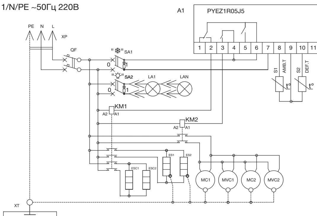
Схема электрическая принципиальная витрины холодильной
